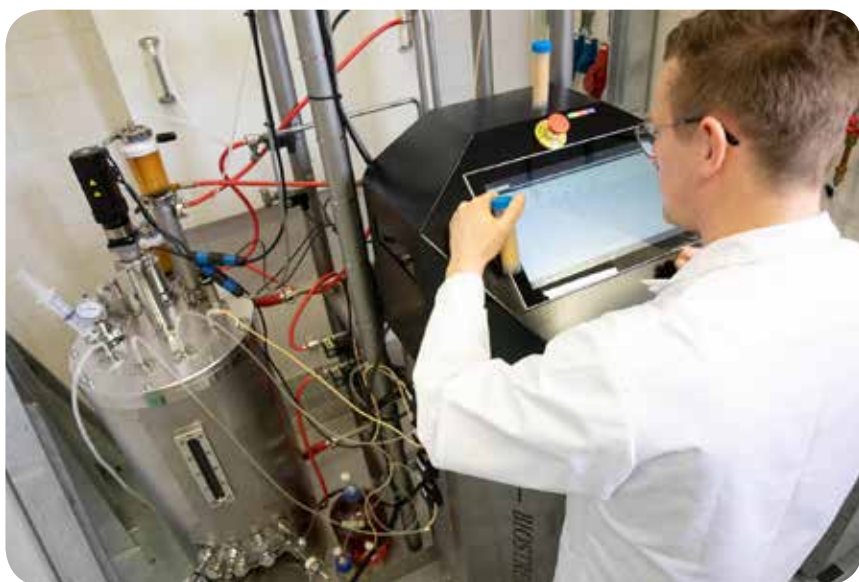
Het microbiële olie project: de nieuwe 80-liter bioreactor voor het cultiveren van gisten die olie produceren.
